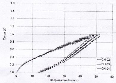
Figura 8. Curva carga – desplazamiento del espécimen MCL-01
