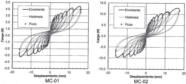
Figura 3. Curva histerética carga-desplazamiento de los especímenes
