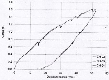
Figura 9. Curva carga – desplazamiento del espécimen MCL-02
