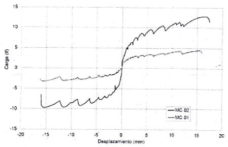
Figura 4. Curva de capacidad de cada espécimen. Relación cargadesplazamiento
