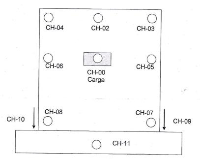
Figura 7. Distribución de sensores para el ensayo perpendicular al plano (unidades: mm)
