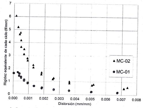
Figura 6. Degradación de la rigidez, en términos de la rigidez equivalente y la distorsión máxima de cada ciclo
