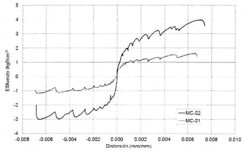
Figura 5. Curva de capacidad de cada espécimen. Relación esfuerzodistorsión
