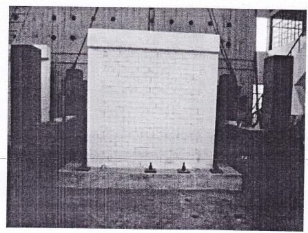
Figura 23. Inicio del ensayo de perpendicular al plano en el espécimen MCL-01
