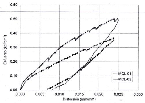
Figura 10. Curva esfuerzo – distorsión del espécimen MCL-01 y MCL-02
