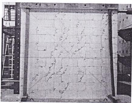
Figura 22. Estado final del espécimen MC-02
