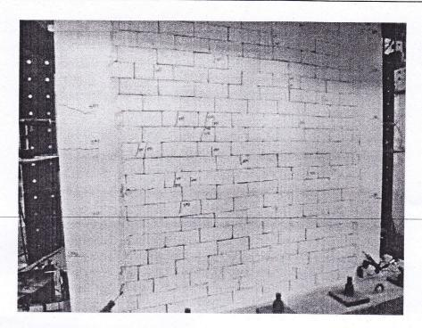
Figura 15. Inicio de grietas en las columnas, distorsión 1/390
